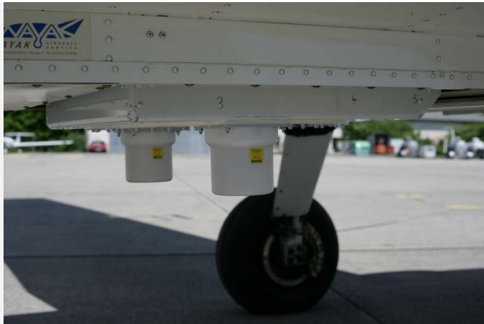
Richtfunkantennen des Diversity-Systems an der Cessna 208B
