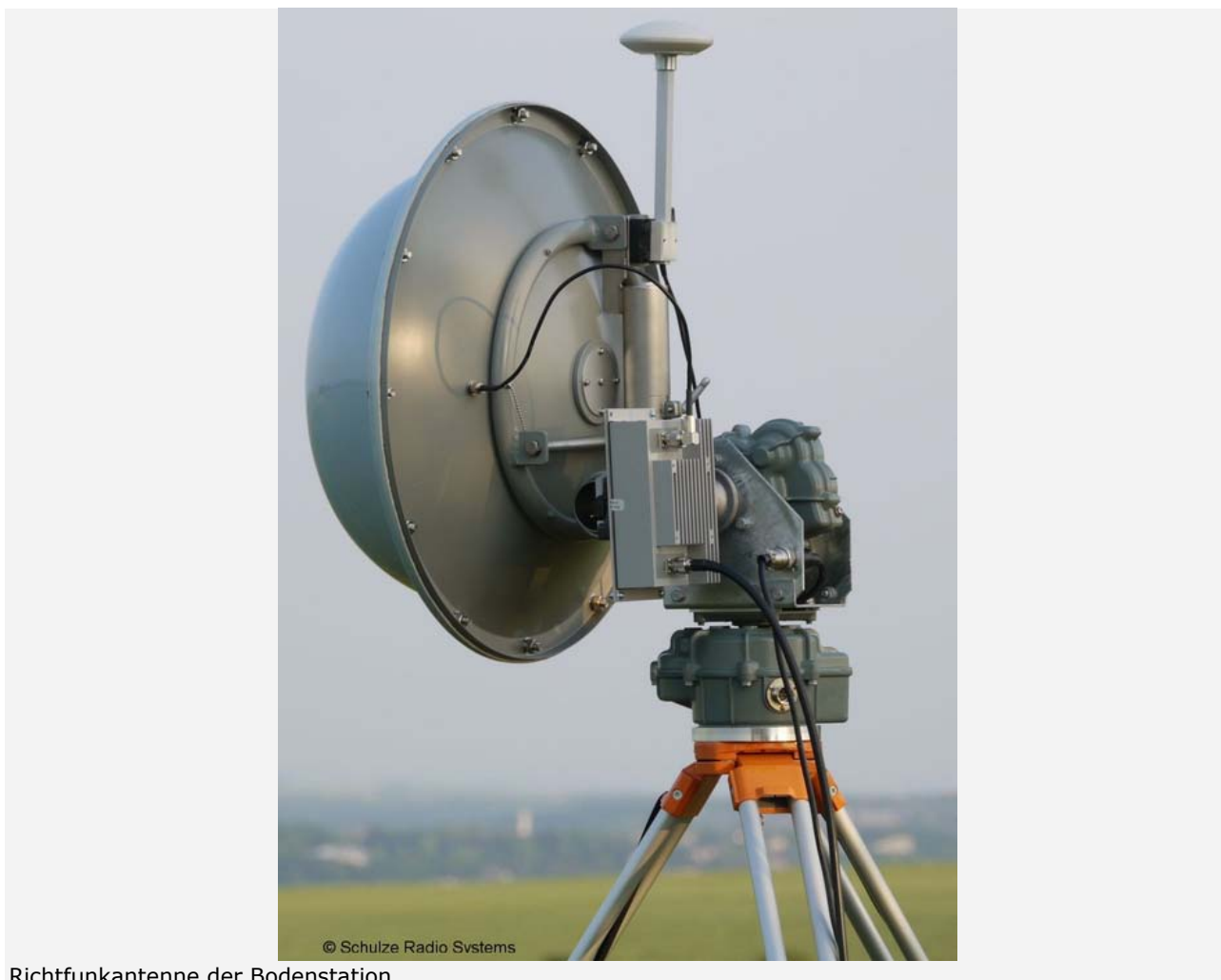
Richtfunkantenne der Bodenstation
