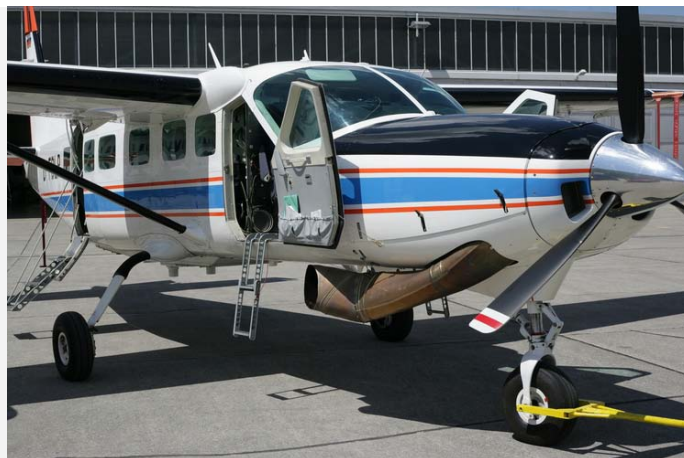
DLR Forschungsflugzeug Cessna 208B mit Mikrowellen-Datenfunk und 3K Kamera Online-System kurz vor dem Start zum Testflug
